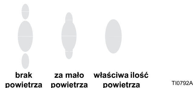
Rys. 8. Problemy związane ze wzorem natryskiwania
