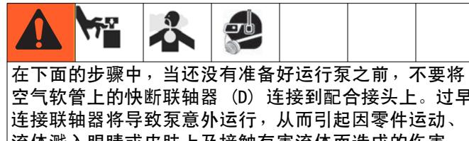
在下面的步骤中，当还没有准备好运行泵之前，不要将空气软管上的快断联轴器 (D) 连接到配合接头上。过早连接联轴器将导致泵意外运行，从而引起因零件运动、流体溅入眼睛或皮肤上及接触有害流体而造成的伤害。
