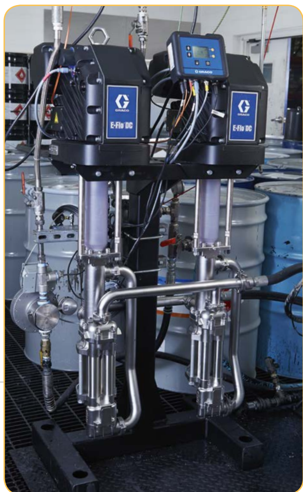
E-Flo DC para alto caudal Volumen de hasta 4000 cm 3 /ciclo
