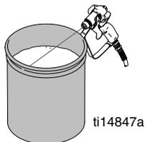
5. Gire la válvula de cebado abajo a la posición de drenaje y permita que el líquido de lavado circule hasta que el líquido de lavado salga transparente.
