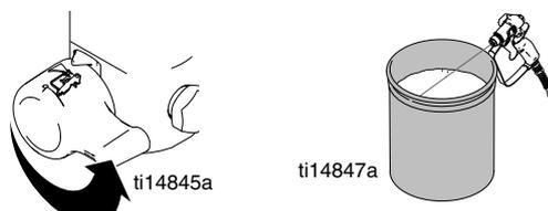
7. Suba el tubo de aspiración por encima del líquido de lavado y haga funcionar el pulverizador durante 15 a 30 segundos para drenar el líquido. **APAGUE** la fuente de alimentación
