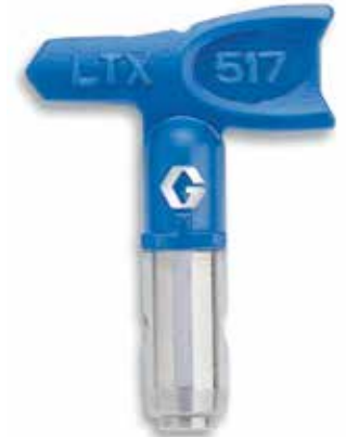
El 517 indica el tamaño de la boquilla: • El tamaño del abanico es el doble del primer dígito (5), o 10 pulgadas. • El tamaño del orificio es (17) milésimas de pulgada o 0,017.
