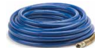
Trenzado sintético, presión máxima de trabajo especificada de 4000 psi (276 bar, 27,6 MPa) a 180 °F (82,2 °C)
