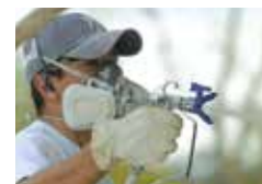
Gatillo de la pistola FTx de 4 dedos: el gatillo de longitud completa es más fácil de sostener en pulverización continua.
