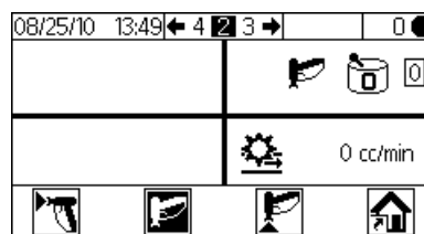
FIG. 19. Pulverización de mezcla en ejecución (pantalla 2)
