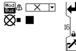
Figure 55 Seleccione para desactivar la función de parada de la bomba del botón Cancelar.
