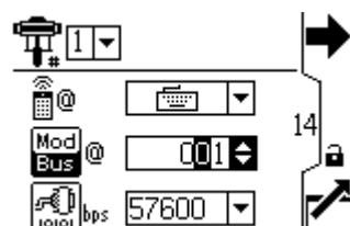
Figure 47 设置 Modbus 节点 ID
