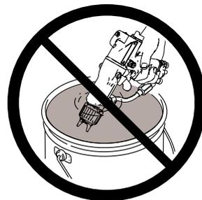
8. Nettoyez le capuchon d'air/le garde-buse et la buse de pulvérisation avec une brosse souple et un solvant ininflammable.
