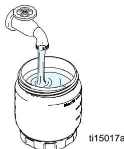
7. Bringen Sie den Materialbehälter wieder an und schütteln Sie das Spritzgerät, um sauberes Wasser im Behälter zu verteilen und alle Bereiche in seinem Inneren zu reinigen.
