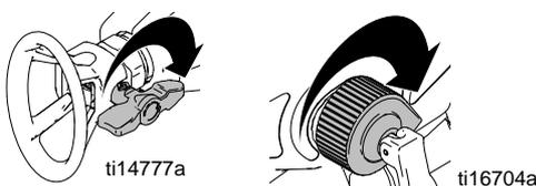
3. Richten Sie das Spritzgerät auf einen Abfallbereich, entriegeln Sie die Abzugssperre und bringen Sie das Entlüftungs-/Spritzventil nach unten in die Spritzposition (DOWN). Betätigen Sie den Abzug, um die Verstopfung zu lösen.
