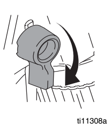
Gâchette déverrouillée (pulvérisation possible)
