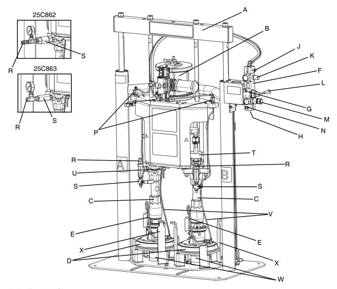
Fig. 1: 1:1 Extruder Components
