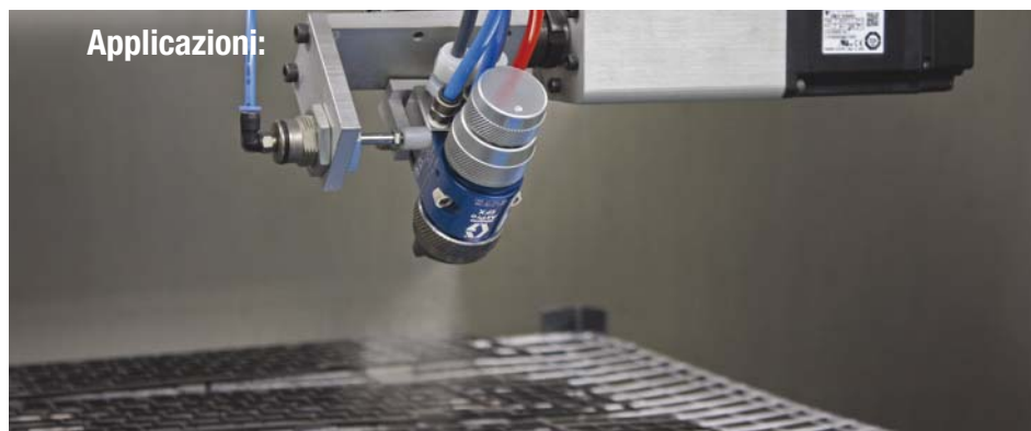
Applicazione automatica pneumatica pistola a spruzzo automatica AirPro EFX™ di Graco.
