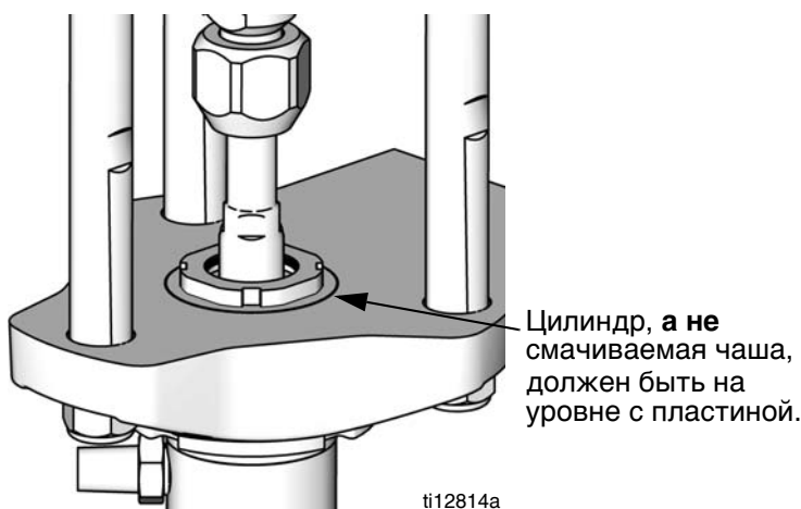
Рис.6. Выровняйте пластину переходника и цилиндр.
