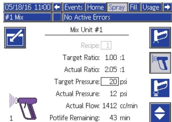
Figure 21 Schermata di spruzzatura, in modalità miscelazione
