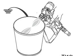
6. Chiudere la valvola dell'aria della pompa del solvente (DA). Premere il grilletto per rilasciare la pressione. Chiudere la valvola di lavaggio del solvente (AD) dopo il rilascio della pressione.
