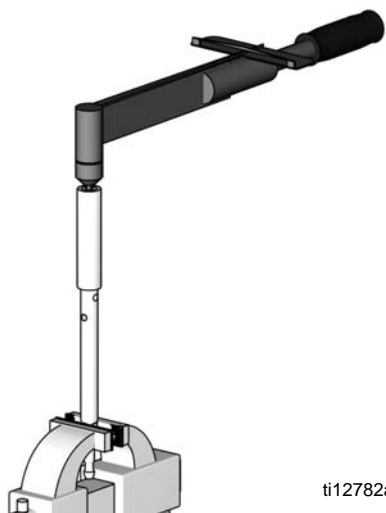
FIG. 2. Rimuovere il dado di flusso passante
