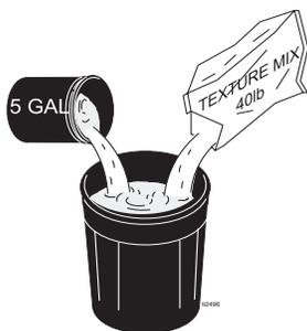
2. Pour bien mélanger, utiliser un agitateur rotatif d'un demi pouce à palettes à vitesse variable jusqu'à obtenir un mélange consistant sans grumeaux.
