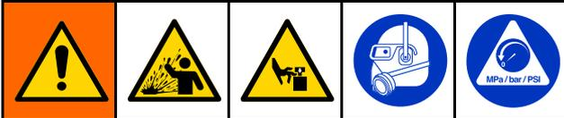
Cet équipement reste sous pression jusqu'à ce que la pression soit relâchée manuellement. Pour éviter de sérieuses blessures provoquées par du liquide sous pression, comme des éclaboussures de liquide et des pièces en mouvement, exécuter la procédure de décompression lorsque l'on cesse le travail et avant un nettoyage, une vérification ou un entretien de l'équipement.
