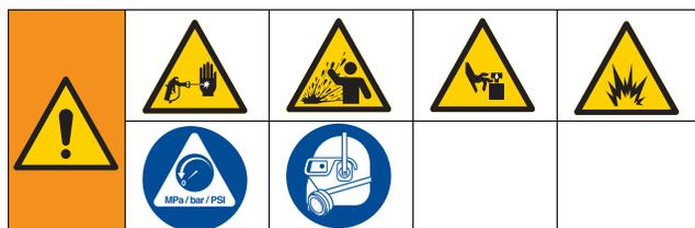
本装置は、圧力が手動で開放されるまでは、加圧状態が続きます。皮膚の貫通などの加圧状態の流体、流体の飛散、および可動部品から生じる重大な怪我を避けるには、スプレー停止後と装置を清掃、点検、および整備する前に、圧力開放手順に従ってください。
