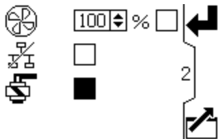
Figure 12 充填ポンプソレノイドの手動制御
