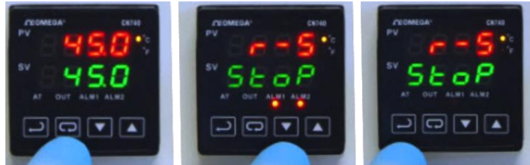
Figura 3-6: Desactivación del calentador
