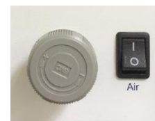
Figura 3-4: Interruptor de aire
