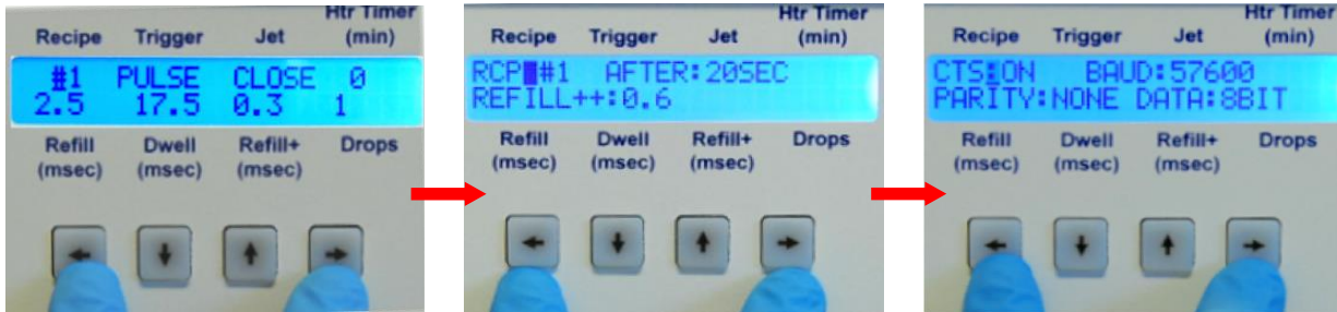
Figura 4-2: pulse las teclas IZQUIERDA + DERECHA dos veces para los ajustes predeterminados de RS-232
