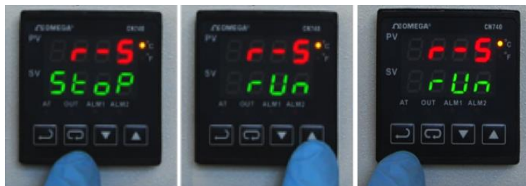
Figura 3-5: Activación del calentador
