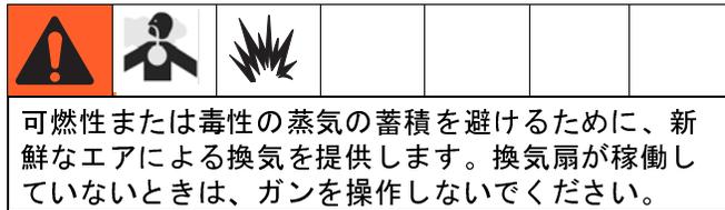
換気扇が稼働していない状態でガンが稼働することを防止するために、ガン給気装置を換気装置と電氣的にインターロックします。排気速度の要件に関するすべての国、州、および地域の法令を確認し、それらを遵守してください。
