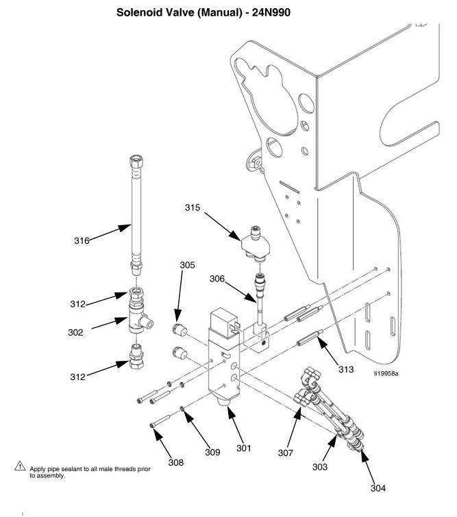
Fig. 30: HFR Semi-Automatic Valve Kit
