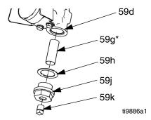
Fig. 18. Fluid Inlet Strainer
