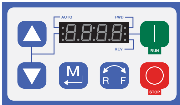
Figure 15 VFD コントロールパネル
