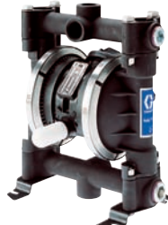
Husky716 3/4インチ (19.1mm) 最大吐出流量61L/分 アルミニウム、SUS316
