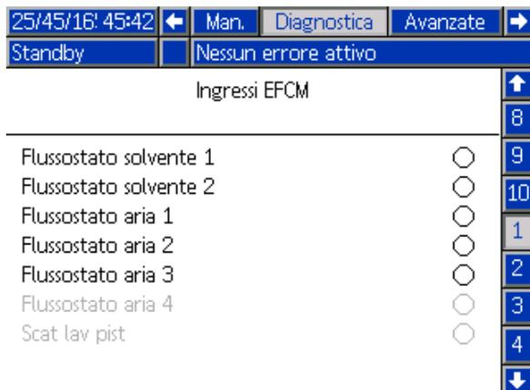
Utilizzare questa schermata per provare e verificare il corretto cablaggio di tutti gli ingressi verso il sistema EFCM (vedere il manuale d'installazione 332457 per dettagli). La schermata mostra tutti gli ingressi disponibili verso l'EFCM, ma evidenzia solo quelli significativi per la configurazione del sistema. Tutti gli ingressi sono normalmente aperti. Quando l'ingresso rileva la chiusura di un interruttore, l'indicatore di stato sullo schermo diventerà verde.
