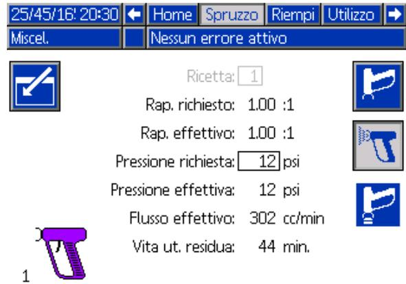
Figure 17 Schermata di spruzzatura, in modalità miscelazione
