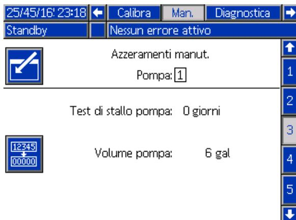
Figure 57 Schermata di manutenzione 3, stato attuale della pompa
