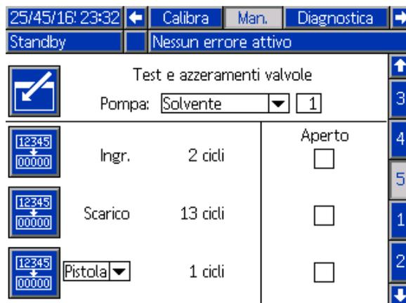
Figure 59 Schermata di manutenzione 4, reset valvola del solvente
