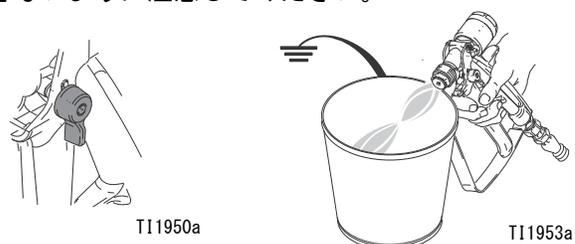
8. 溶剤ポンプエアバルブ (DA) を開きます。溶剤ポンプエアレギュレータ (DB) を時計回り方向にゆっくり回し、溶剤ポンプに溶剤を吸い込ませ、混合ホースとガンからエアを押し出します。エアがすべて取り除かれるまでガンをトリガーします。
