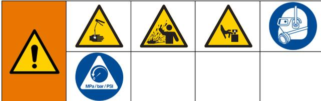
本装置は、圧力が手動で開放されるまでは、加圧状態が続きます。皮膚の貫通などの加圧状態の液体、液体の飛散、および可動部品から生じる重大な怪我を避けるには、ディスペンス停止後と装置を清掃、点検、および整備する前に、圧力開放に従ってください。
