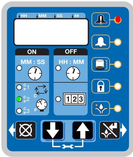
圧力モードにおいて、装置に対して過剰な圧力がかかっている、もしくは潤滑サイクルがユーザー規定の時間数の範囲内で完了しなかったことを示している。
