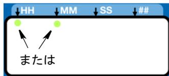
1. 所望の数が最初の時間(HH)フィールド内に表示されるまで、上矢印ボタンと下矢印ボタンを使用して0～2の番号の中を上下に移動します。
