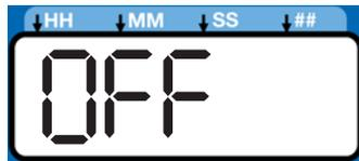
2. 上下矢印ボタンを押してディスプレイ上で OFF を ON に変更してアラーム出力を安定化させます。
