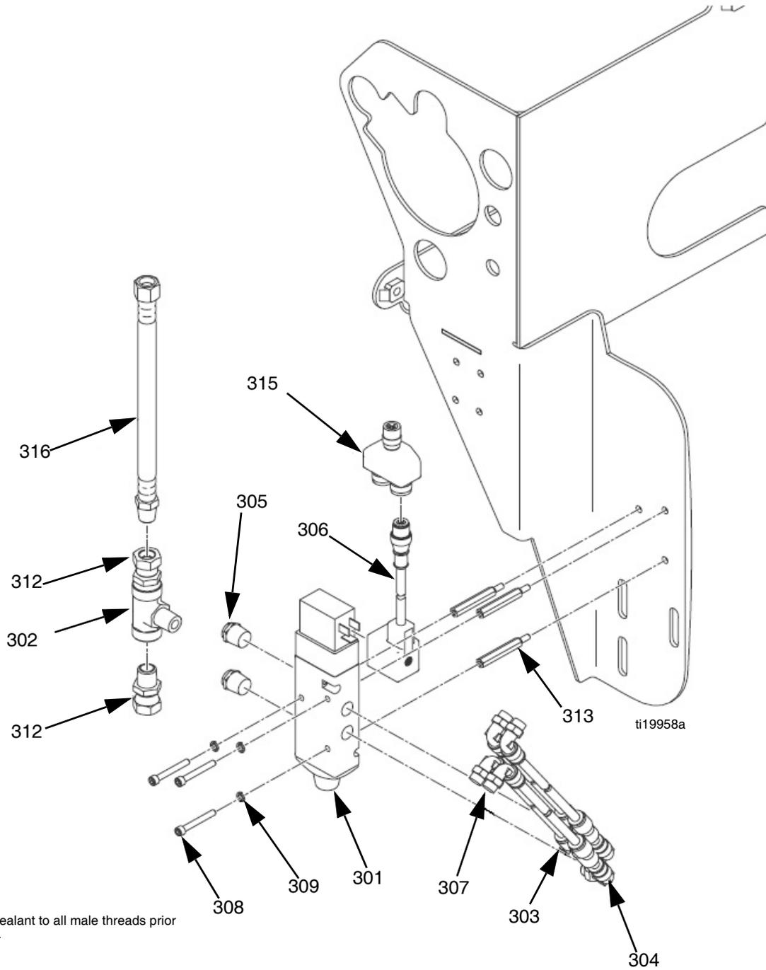
**FIG. 30: HFR Semi-Automatic Valve Kit**
