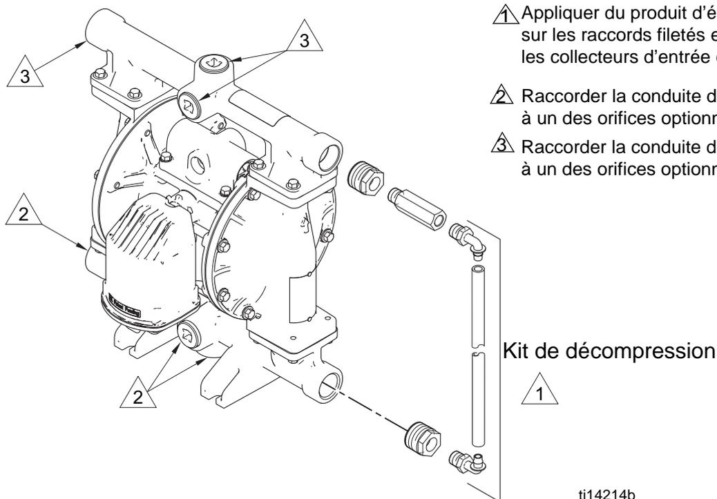
1 Appliquer du produit d'étanchéité pour filetage sur les raccords filetés et installer le kit entre les collecteurs d'entrée et de sortie du produit.
