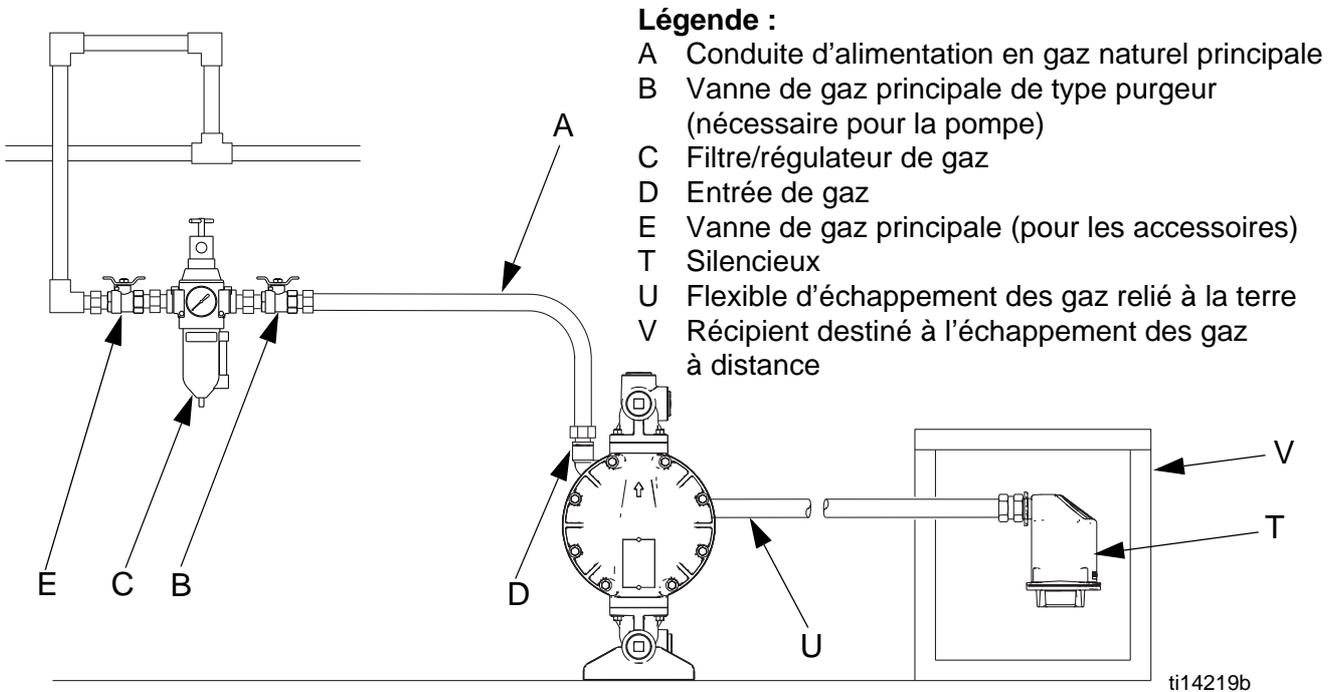
**FIG. 2. Évacuation des gaz d'échappement**
