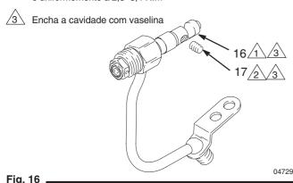
4. Instale a guia da mola (16) e encoste-a à agulha. Aperte um pouco ambos os parafusos de aperto (17) na guia da mola, depois aperte-os alternadamente e uniformemente a 1,1–1,6 N.m. Encha as cavidades dos parafusos de aperto com vaselina.
