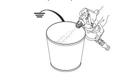
Limpe sempre a bomba e a pistola antes que o fluido utilizado na pulverização tenha tempo de secar lá dentro.
