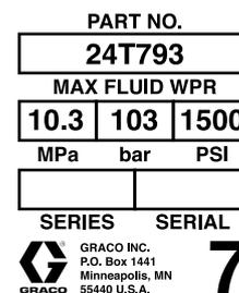
Figure 2 Étiquette d'identification de la pompe 70 CC
