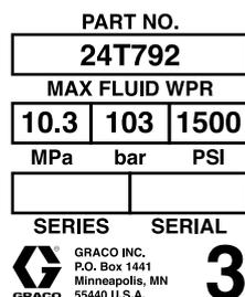
Figure 1 Étiquette d'identification de la pompe 35 CC
