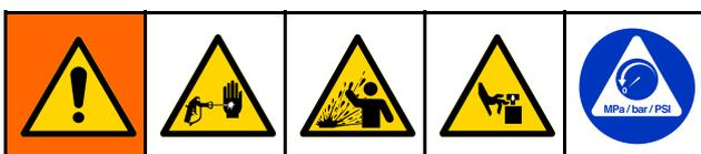
Cet équipement reste sous pression jusqu'à ce que la pression soit relâchée manuellement. Pour éviter de sérieuses blessures provoquées par du fluide sous pression (comme des injections cutanées), des éclaboussures de fluide et des pièces en mouvement, exécutez la **Procédure de décompression** du manuel de votre appareil lorsque vous arrêtez la pulvérisation et avant un nettoyage, une vérification ou un entretien de l'équipement.
