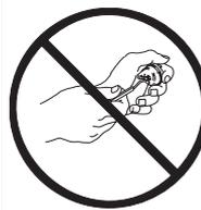
Verwenden Sie keine Metallwerkzeuge zur Reinigung der Luftkappen oder der Materialdüse, da sie dadurch zerkratzt werden können. Achten Sie darauf, dass die Elektrode nicht beschädigt ist.
