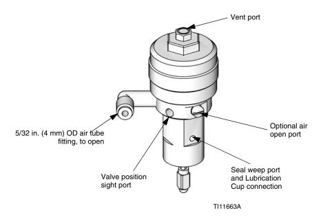
Fig. 1. Valve Air Ports
