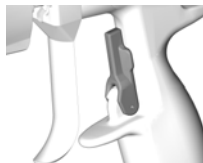
Avtrekkeren er ulåst (sprøyting)
