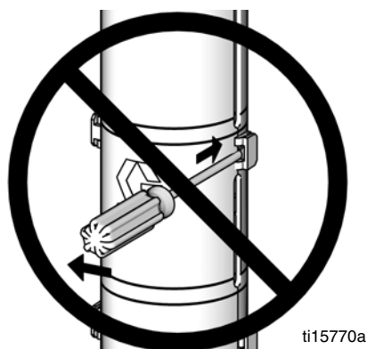
AFB. 4. Het spatscherm demonteren
