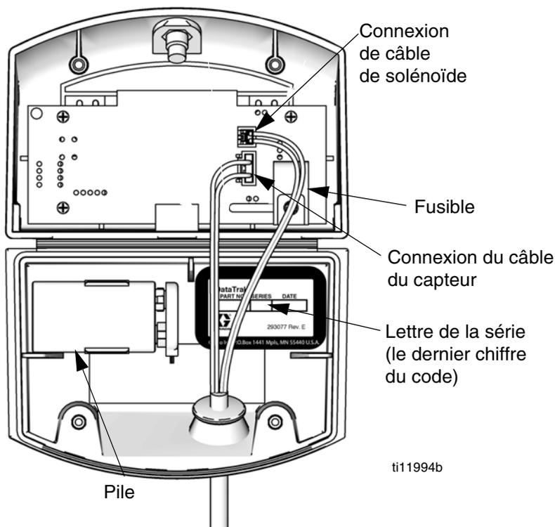
Fig. 4. Emplacement de la pile et du fusible de DataTrak
