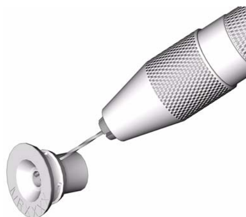
Рис. 2. Прочистка отверстий для компонента В (полимер)
