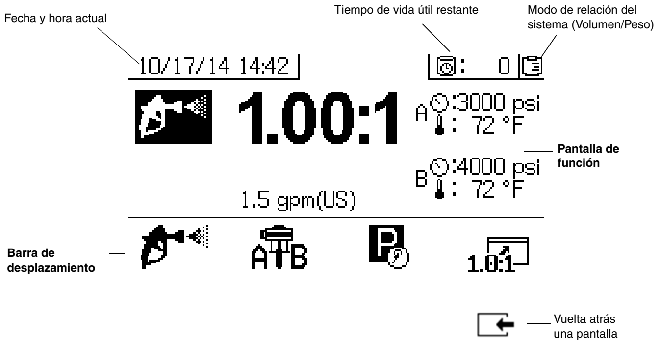
FIG. 7: Componentes de la pantalla principal (mostrados con todas las funciones de pantalla habilitadas)
