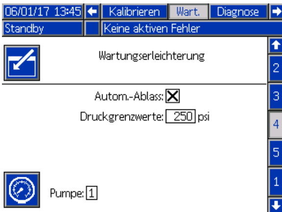
Figure 63 Wartungsbildschirm 4, Manuelle Druckentlastung der Pumpen
