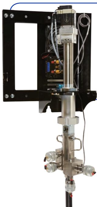
Уникальные насосы, установленные в системах ProMix PD2K, используют технологию вытесняющего действия и прекращают работать под давлением, что позволяет обеспечить равномерную подачу ЛКМ и точное соблюдение заданного соотношения компонентов!
