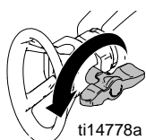
ti14778a Dyse vendt fremover (SPRØYTE-stilling)
