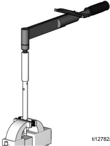
ABB. 2. Entfernen der Durchflussmutter
