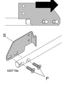
5. Replace the LL250-style cable stud with LL200-style cable stud.
