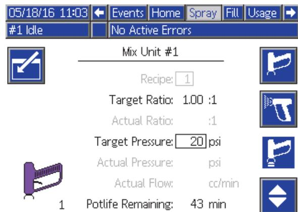
Figure 22 Écran de pulvérisation, en mode inactif
