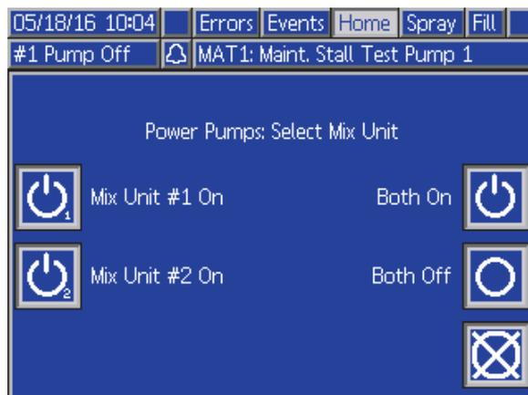
Les touches programmables permettent de mettre sous tension un mélangeur ou les deux en même temps. L'état du système passera de « Système désactivé » à « Démarrage ». Une fois que les pompes sont sous tension et en position d'accueil, l'état du système passera de « Démarrage » à « Veille ».
