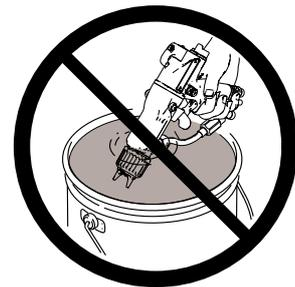
8. Limpie el cabezal de aire/la protección de la boquilla y la boquilla de pulverización con un cepillo suave y un disolvente no inflamable.
