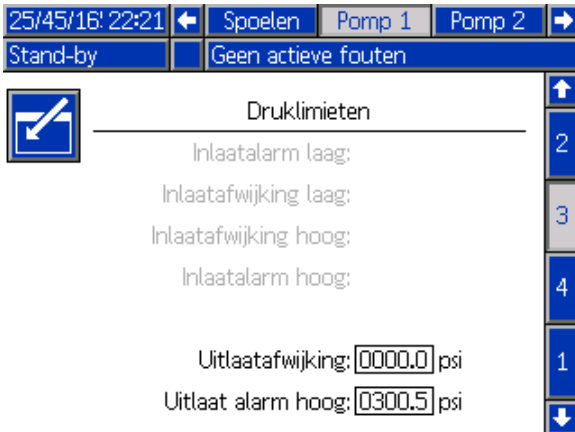
Figure 46 Pompscherm 3, Drukbevaking uitgeschakeld
