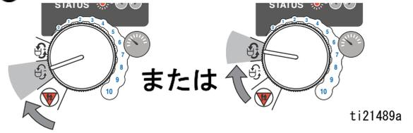
8. きれいな液が両方の再循環チューブ (P) から流れ出たら、機能ノブを停止 / パーキング に設定します。
