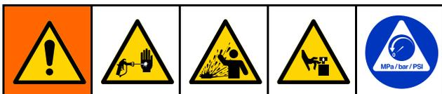
L'apparecchiatura rimane pressurizzata finché la pressione non viene rilasciata manualmente. Per evitare gravi lesioni causate dal fluido pressurizzato, come iniezioni nella pelle, dagli spruzzi di fluido e dalle parti in movimento, seguire la **Procedura di rilascio pressione** riportata nel manuale del sistema al termine della spruzzatura e prima di pulire, verificare o eseguire la manutenzione dell'apparecchiatura.
